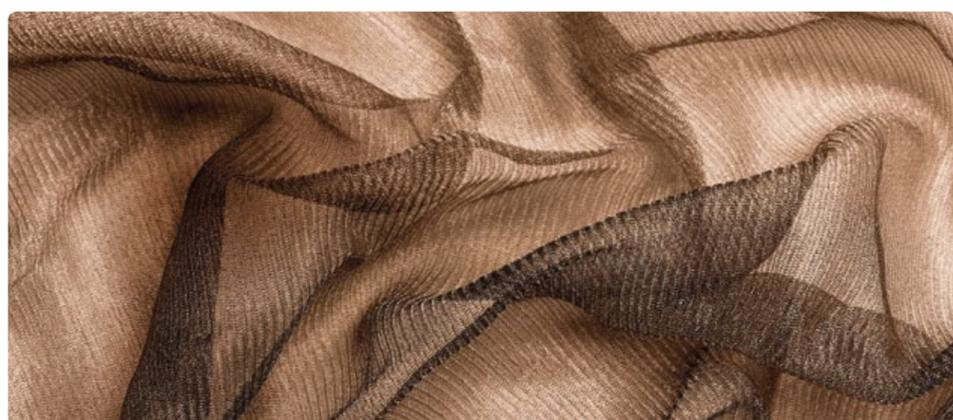
Feinmaschiges Katalysatornetz aus haarfeinen Platin-Rhodium-Fäden zur Herstellung von Salpetersäure.
