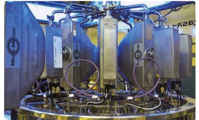
(SPS). Darüber hinaus erlaubt der weite Bereich des Coriolis Durchflussmessgerätes, unterschiedliche Medien zu verteilen, ohne ein mechanisches Element der Maschine auszutauschen. Es sind Füllungen von 0,5 g bis 5 kg möglich. Die hohe Zuverlässigkeit und die genauen Ergebnisse des Micro Motion Gerätes wurden von GF-Kunden in einer Anzahl erfolgreicher Anwendungen bestätigt.
