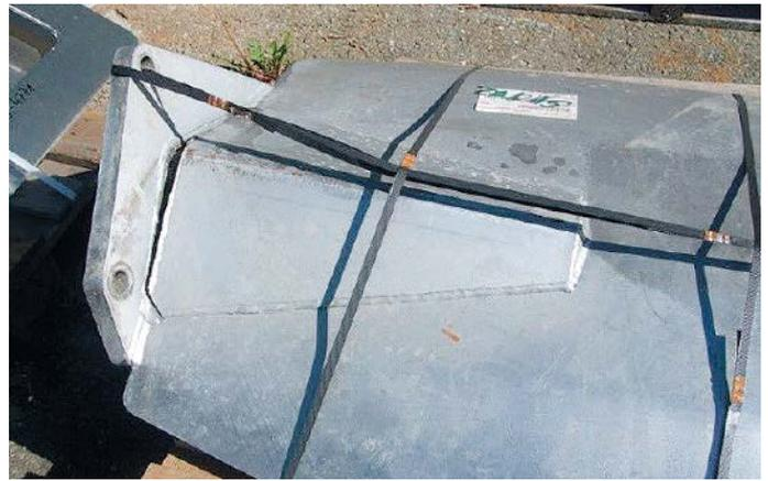
Abb. 3a+b: Schwingungsbrüche an Rührelementen durch Fehlkonstruktion.
