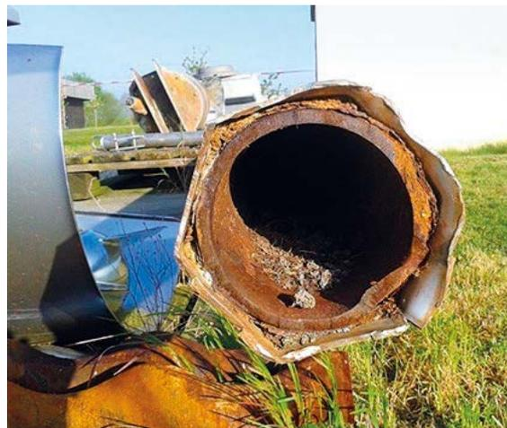
Abb. 2b: An der Kupplung gebrochene Rührerwelle.
