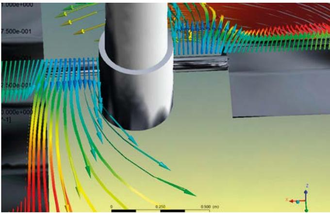
Abb. 1a: Strömungstechnisch optimiertes Theta Rührerelement.
