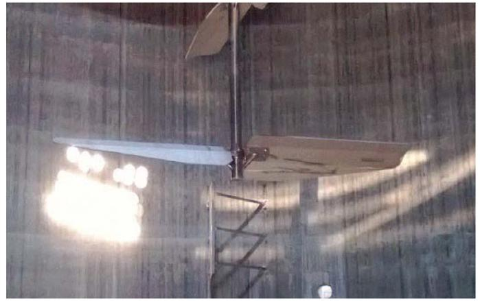
Abb. 1b: Flach angestelltes Rührerelement mit hoher Verzopfungseigung und verminderter Förderwirkung.
