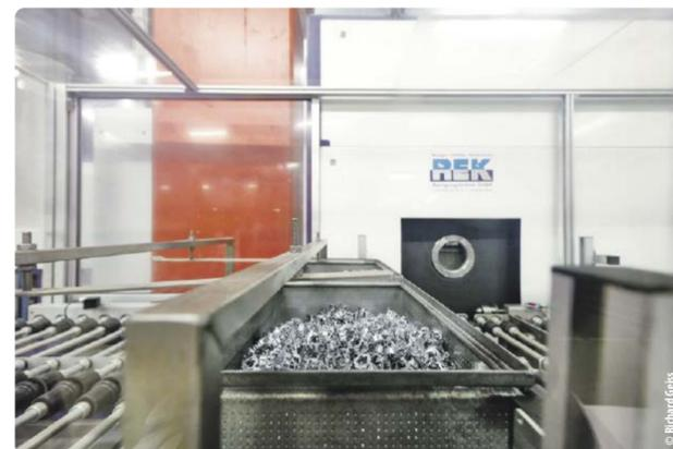
Einzelteile für die Schrittmotoren nach dem Entfettungsprozess
