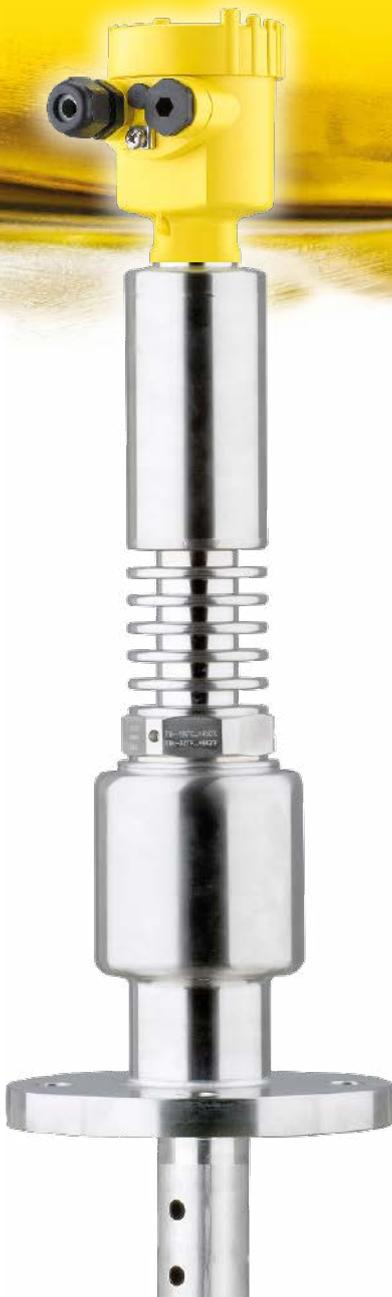
Der Vegaflex 86 verfügt über eine Keramikisolierung und Graphitdichtung in der Einkopplung, die dem Eindringen von Dampf mit max. 400 bar Druck und 450 °C standhalten können.
