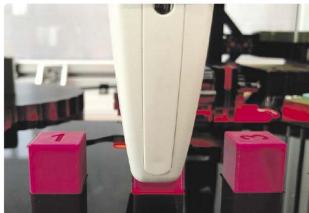
Mittels eines Vision-Sensors werden die Objekte anhand der Innen- und Außenkontur eindeutig identifiziert und entsprechend der Vorgaben am definierten Ablageort platziert.
