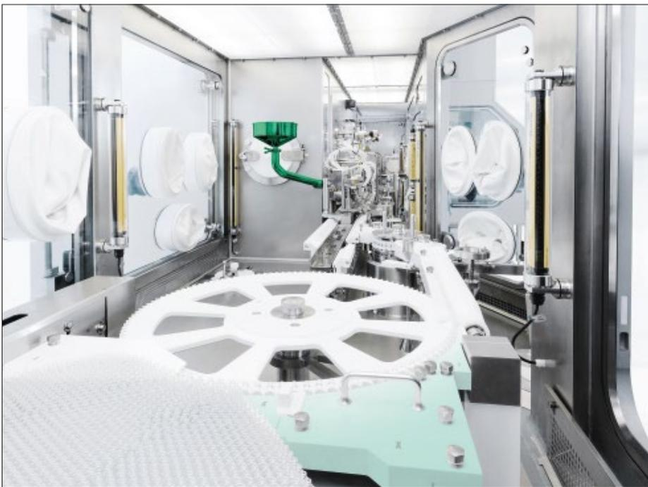
**Abb. 2:** Besonders bei neuen Linien sollten Dekontamination, Produktoxidation und die zulässige Restkonzentration von  $H_2O_2$  bereits in der Design- und Engineeringphase berücksichtigt werden, um deren Auswirkungen auf die Zykluszeiten zu minimieren. © Syntegon
