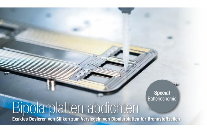
Betrachtet man Markt und Reifegrad der Brennstoffzellentechnologie ist festzustellen, dass Anwendungen zwar noch einen geringen Marktanteil beanspruchen, jedoch bereits stark an Dynamik zugelegt haben. Passend zu dieser Entwicklung fanden kürzlich Dosierversuche im Viscotec-Technikum mit einem Wacker Silikon statt, um Bipolarplatten für Brennstoffzellen zu versiegeln.
