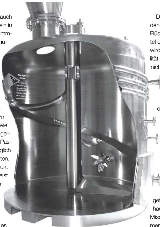
Prinzipdarstellung eines Vakuumtrockners
