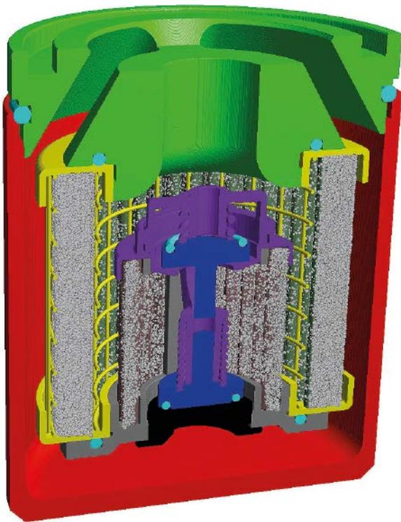
◀ Visualisierung einer Filtrationssimulation über 20 Batches (50s/Batch, 1000s Filtrationszeit). Jeder Batch enthält etwa 84 Mio. Partikel (1,7 Mrd. Partikel/20 Batches). Das Bild zeigt die abgelagerten Partikel durch die äußeren und inneren Falten, bei geöffnetem Ventil.
