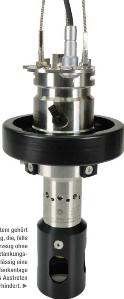
Zum H<sub>2</sub>-Betankungssystem gehört eine Nottrennkupplung, die, falls sich das betankte Fahrzeug ohne Abkuppeln von der Betankungsstelle entfernt, zuverlässig eine Beschädigung der Tankanlage und unkontrolliertes Austreten von H<sub>2</sub> verhindert. ►
