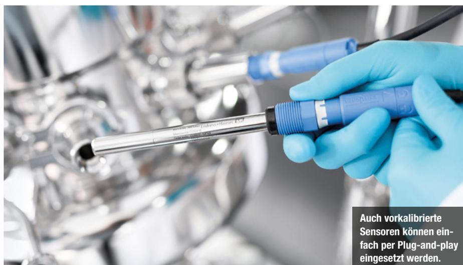
Auch vorkalibrierte Sensoren können einfach per Plug-and-play eingesetzt werden.
