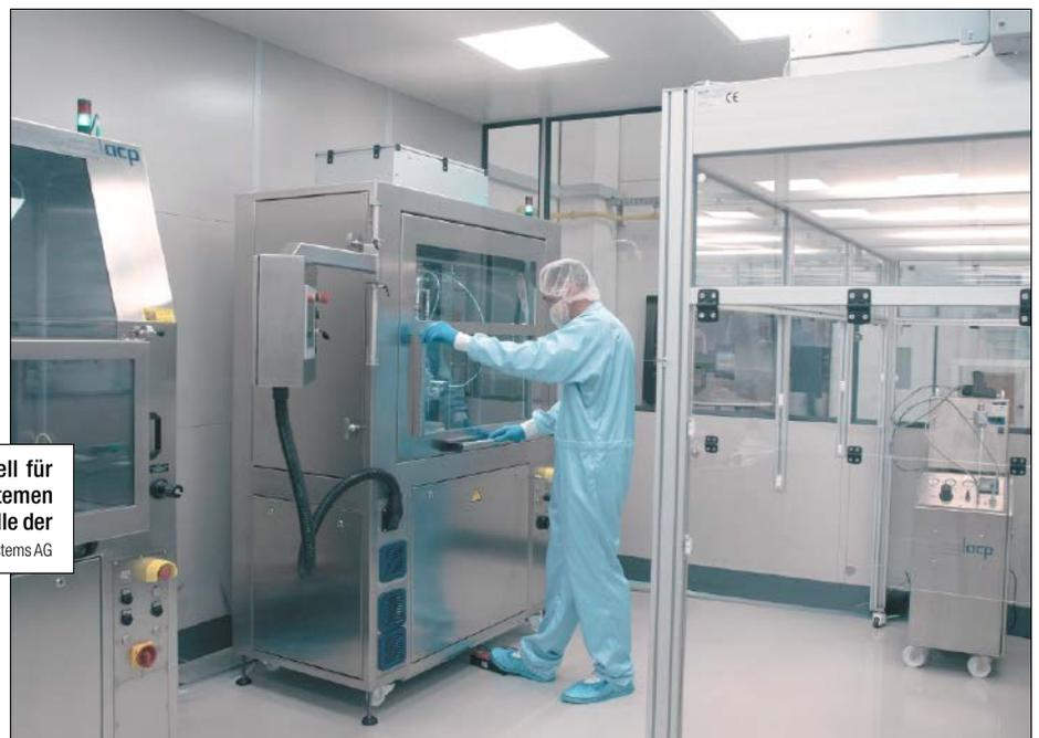
Ausgestattet ist das Reinraum-Technikum mit speziell für High Purity-Anwendungen ausgelegten Reinigungssystemen sowie verschiedenen Nachweisttechnologien zur Kontrolle der erzielten partikulären und filmischen Sauberkeit. © acp systems AG
