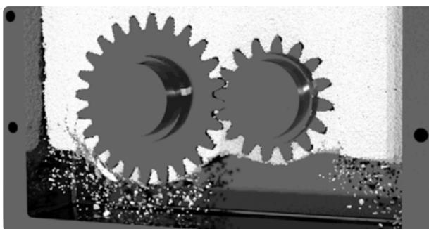
Dive Solutions-Software DICE: Getriebe-Simulation mit Visualisierung des Öls (oben) und der Luft (unten)
