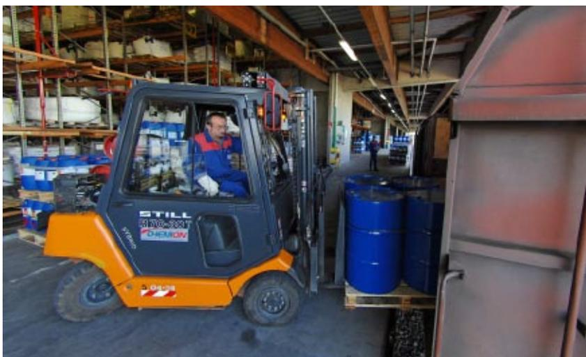
Abb. 4: Überall da, wo es in Produktion, Lager und Distribution zu explosionsfähiger Atmosphäre kommen, ist für Gabelstapler aus Sicherheitsgründen ein besonderer EX-Schutz notwendig.
