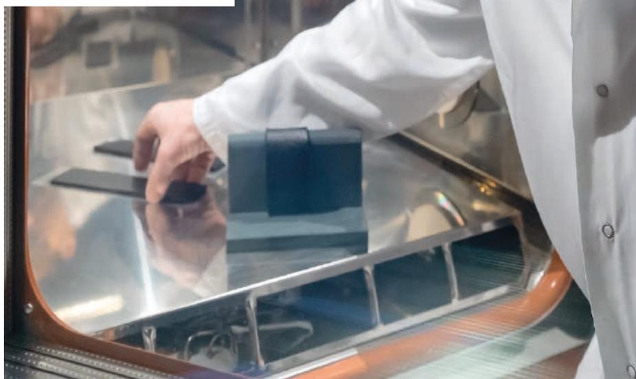
Abb. 1: Um die Eigenschaften von Bitumen unter bestimmten klimatischen Bedingungen zu testen, werden Rissüberbrückungstests durchgeführt.
