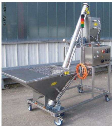
**Förderschnecken von EAP Lachnit sind die beste Wahl, um Schüttgüter oder pulverförmige Stoffe in der Lebensmittel-, Chemie- und Pharmaproduktion zu transportieren.**
