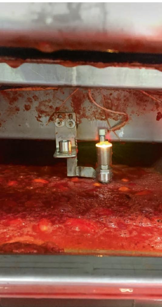
**Abb. 4: Obwohl die Verarbeitung von Tomaten auf den ersten Blick nicht besonders komplex erscheint, fordert die Säure der Tomaten von Sensoren einiges ab. Bei einem italienischen Hersteller von Tomatensoße sorgte der Vegapoint 21 vom Start weg für stabile und genaue Füllstandswerte.**
