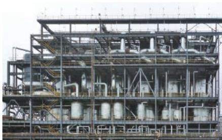
ausreichender Reinigungsfrequenz arbeitet. Mit dieser dritten Verdampferlinie kann die Gesamtkapazität von bislang 1,5 Mio. t/a Aluminiumoxid pro Jahr auf 2 Mio. t/a Jahr gesteigert werden. Der Lieferumfang umfasst auch Anlagenkomponenten wie Druckbehälter, Wärmetauscher, Pumpen, Tanks und Separatoren, Prozess- und Versorgungsleitungen sowie die Instrumentierung und Inbetriebnahme. [www.gea.com](http://www.gea.com)
