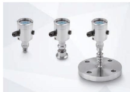
und/oder hohen Temperaturen kann er mit Druckmittlern der Optibar DSP Serie kombiniert werden, die ein breites Spektrum an Spezialwerkstoffen und eine Temperaturentkopplung bis 400 °C/752 °F bieten. Der Messbereich reicht von 0,1...100 bar/1,45...1450 psi, mit einem kleinsten Messbereich von 100 mbar/1,45 psi und einer Messgenauigkeit von ±0,1 % der eingestellten Messspanne.
