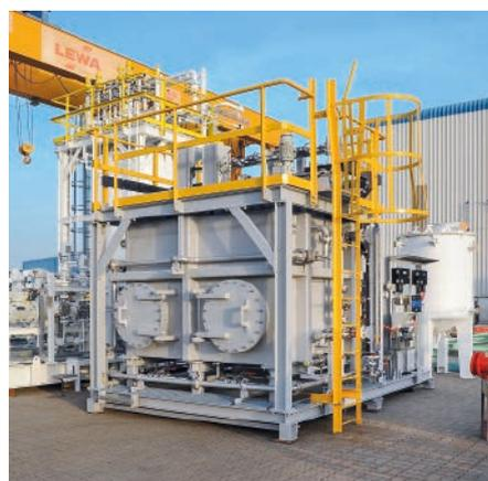
**Abb. 1:** Das Chemical Injection Package für die Förderung von Natriumhypochlorit-Lösung.
