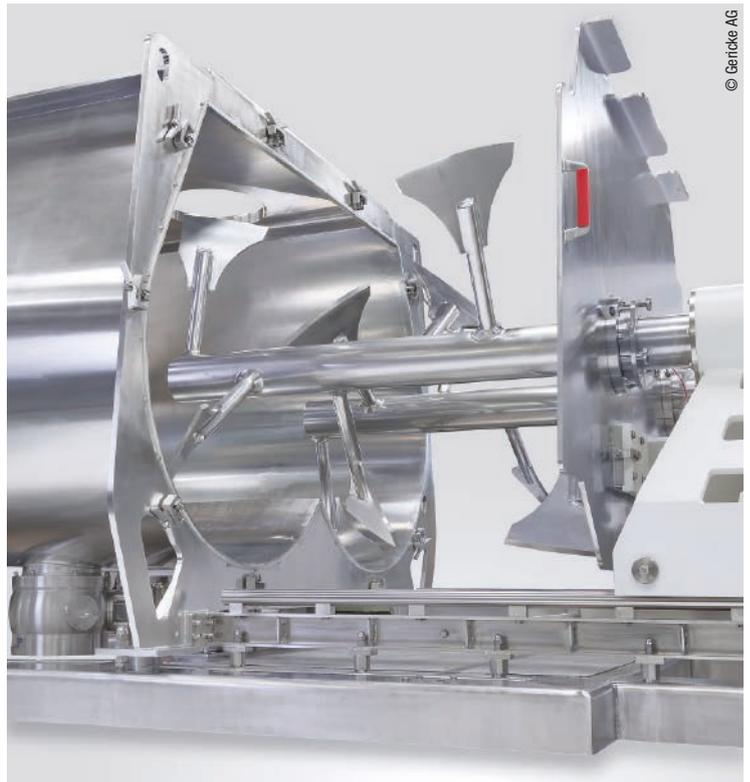
Abb. 1: Alle Bereiche und Oberflächen sind zugänglich und leicht zu inspizieren.
