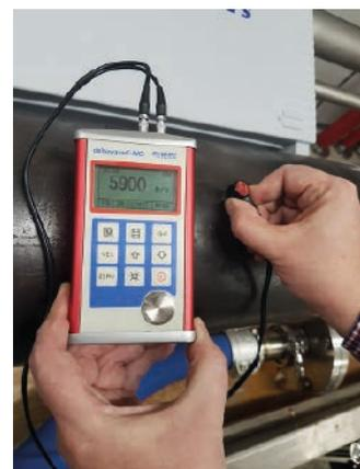
und sofort zeigt das Gerät die Rohrwanddicke an. Zur Stromversorgung genügen zwei Mignonbatterien vom Typ AA 1,5V.
