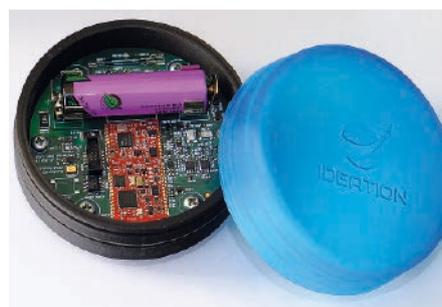
der Instandhalter zuverlässig auf seiner Android App über abnormale Zustände eines Ventils informiert und die Informationen eventuell noch via IIoT/NB Gateway weitergeleitet in Richtung Wartungssoftware. Die Installation erfolgt am Sicherheitsventil
