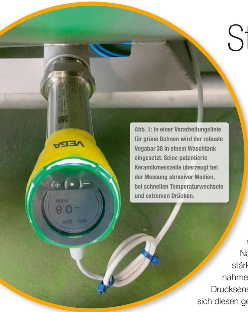
Abb. 1: In einer Verarbeitungslinie für grüne Bohnen wird der robuste Vegabar 38 in einem Waschtank eingesetzt. Seine patentierte Keramikmesszelle überzeugt bei der Messung abrasiver Medien, bei schnellen Temperaturwechseln und extremen Drücken.
