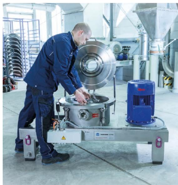
▲ Abb. 3: Die neuen Schlagelemente bilden die neuen Leistungsträger für die ACM Sichter-mühle.
