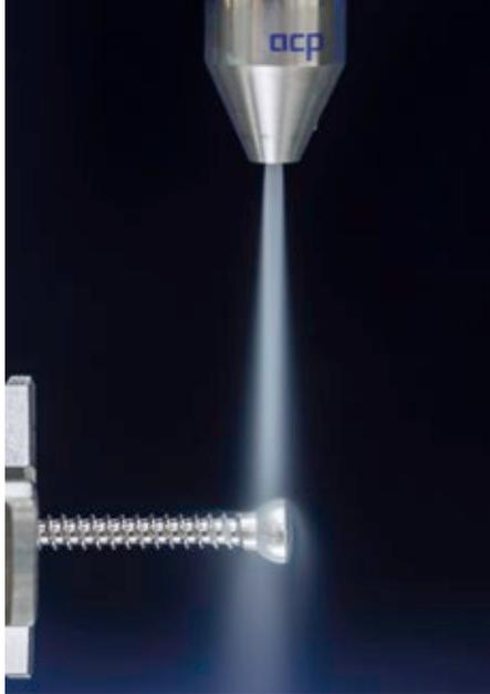
**Abb. 1:** Das in verkettete Produktionsumgebungen integrierbare quattroClean-System ermöglicht die partielle oder ganzflächige Abreinigung partikulärer und filmischer Kontaminationen von praktisch allen technischen Werkstoffen in reinen Umgebungen.
