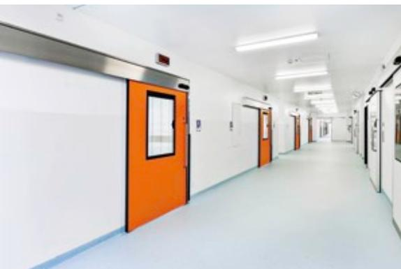
**Abb. 3: Die automatischen Schiebetüren besitzen Verglasungen mit innenliegenden Rollos.**
