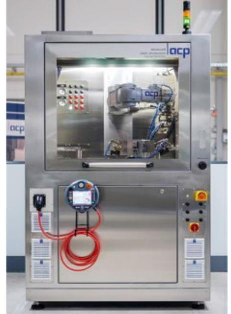
**Abb. 3:** Bei dem für eine Anwendung in der Medizintechnik ausgelegte und in einen Reinraum integrierte quattroClean-System führt ein Roboter die Teile dem Strahlprozess zu.
