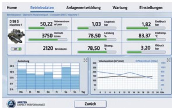
Abb.: Aersmart ist eine übergeordnete Maschinensteuerung zur effizienten Kombination unterschiedlicher Maschinentechologien, egal ob die Kläranlage mit Verdränger- und/oder Strömungsmaschinen betrieben wird.
