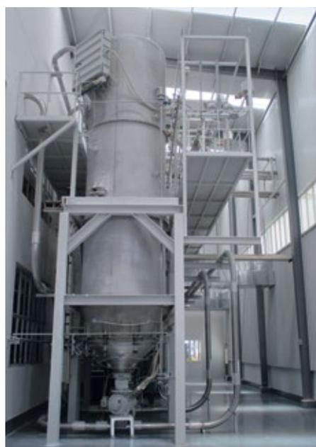
Abb. 3: Großkomponentenwaage
