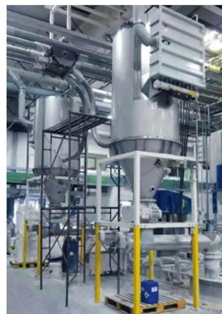
Abb. 5: Automatische Dissolverbeschickung
