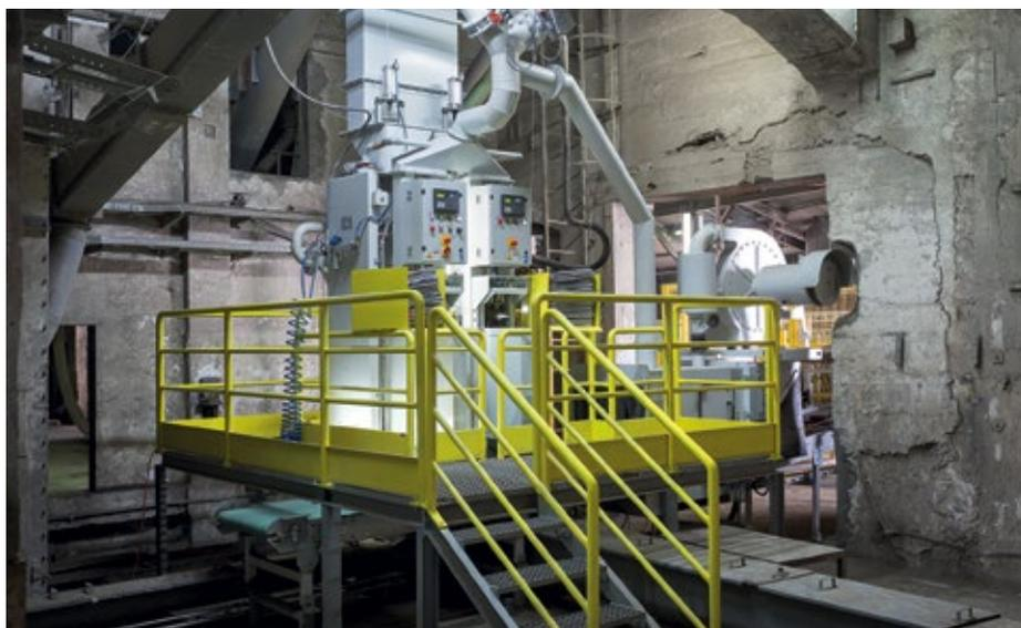
◀ **Abb. 2:** In der Zementindustrie sind Abfüllanlagen üblich, die nach dem Turbinenprinzip arbeiten. Weil die Zement-Zusammensetzungen bei Calucem aber sehr unterschiedlich sind, oft feiner als herkömmlicher Zement, setzt der Hersteller auf eine Luft-Abfüllmaschine vom Typ Beumer fillpac.
