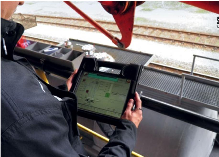
Abb. 3: Die Mitarbeiter werden über Tablet und WLAN durch den gesamten Abfüllprozess geführt und können sich innerhalb der Anlage bewegen.
