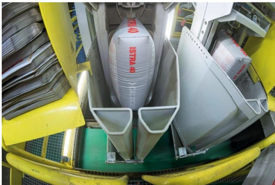
**Abb. 3:** Beim Abfüllen mit dem Beumer fillpac wird nur minimal Staub freigesetzt.
