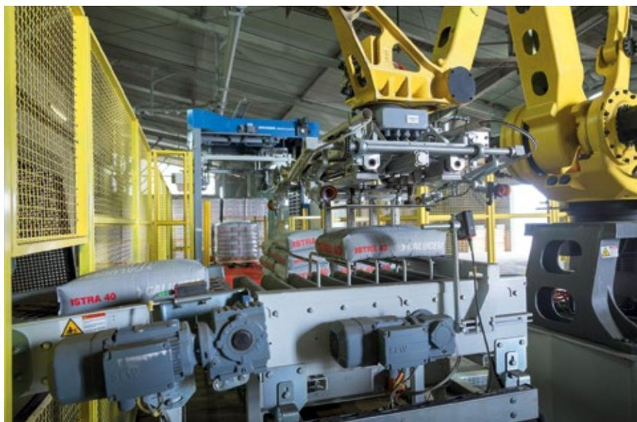
**Abb. 4:** Gestapelt werden die Säcke mit dem Beumer robotpac. Dieser Palettierroboter ist platzsparend und äußerst energieeffizient.
