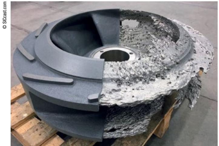
Abb. 2: Der extrem verschleißfeste Werkstoff eignet sich auch für die Reparatur und Aufarbeitung vorhandener Bauteile.
