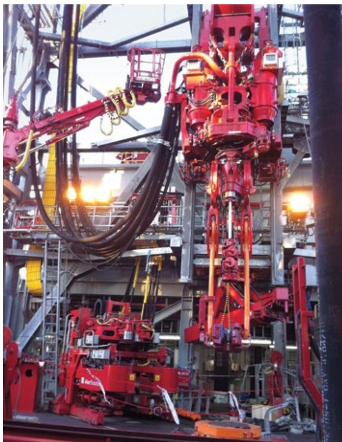
**Abb. 2: Auf Bohranlagen wie bspw. von Aker Solutions können antistatische Kabel Gefahren von zündfähigen Atmosphären verringern.**
