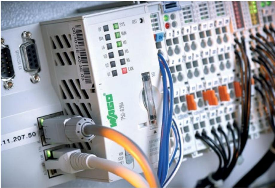
Abb. 2: Universalgenie und Datensammler – das Wago-I/O-System 750: Über 500 I/O-Module, 60 Steuerungen und 40 Feldbusan Kopplungen.
