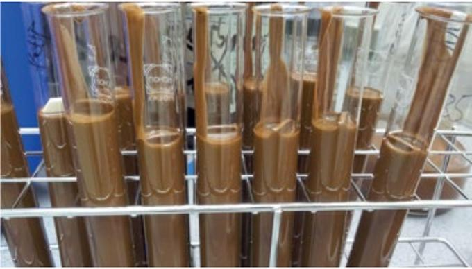
Abb. 1: Die antistatischen Leitungen haben auch die Beständigkeitsprüfung gegen Ölbohrschlamm bestanden.
