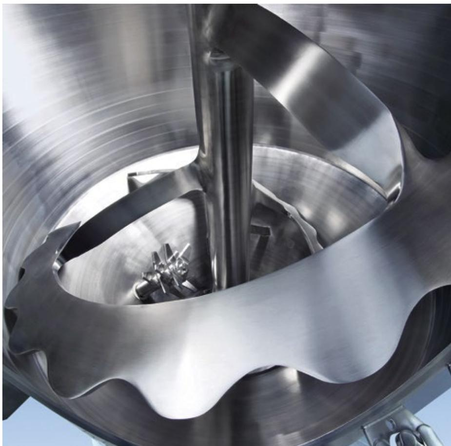
Abb. 2: Das patentierte SinConvex-Mischwerkzeug gewährleistet eine sehr hohe Mischgüte und eine nahezu restlose Entleerung des Misch-Reaktors.
