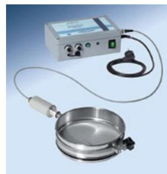
Ultraschallanregung der Reibungswert zwischen Gewebe und Partikel reduziert wird.
