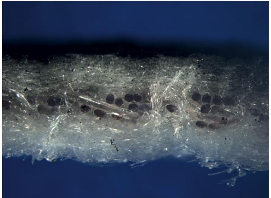
**Abb. 3: Aktivkohle-Filtration mit Nadelフィルz Filterbändern**
