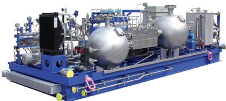
Abb. 1: Typisches Hochdruck-Pumpenaggregat für die Injektion bei der Öl- und Gasförderung mit Resonatoren an Saug- und Druckseite
