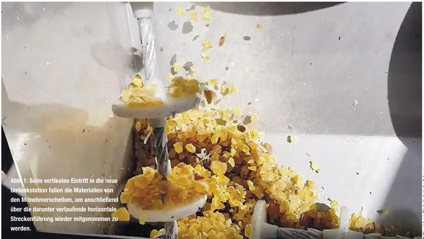
Abb. 1: Beim vertikalen Eintritt in die neue Umlenkstation fallen die Materialien von den Mitnehmerscheiben, um anschließend über die darunter verlaufende horizontale Streckenführung wieder mitgenommen zu werden.
