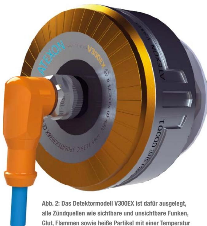
**Abb. 2:** Das Detektormodell V300EX ist dafür ausgelegt, alle Zündquellen wie sichtbare und unsichtbare Funken, Glut, Flammen sowie heiße Partikel mit einer Temperatur von nur 300 °C zu erkennen.
