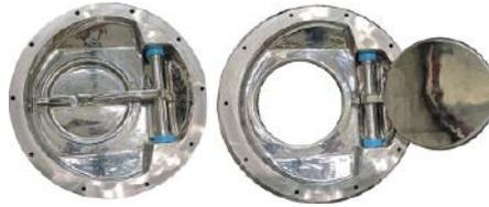
Auslaufklappe schließt dank einer aufblasbaren Dichtung auch bei klebrigem Produkt dicht ab. Darüber hinaus ermöglicht diese Konfiguration die Überwachung der Dichtheit der Auslassklappe und im Falle einer Fehlfunktion könnte der Prozess sofort gestoppt werden, wodurch sich Produktrückrufe vermeiden lassen.
