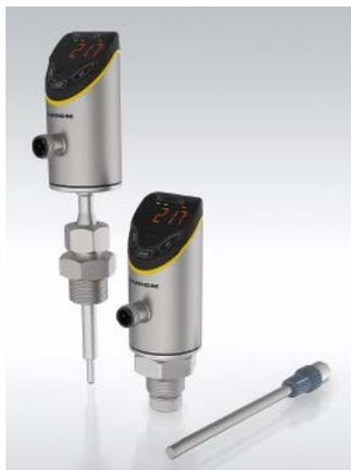
vorkommende Fehlerquelle eliminiert wird. Kompaktgeräte der Bauform TS700 arbeiten in einem Messbereich von -50 bis +150 °C. Abhängig vom angeschlossenen Temperaturfühler, decken Auswerte- und Anzeigeeinheiten vom Typ TS720 sogar Temperaturbereiche zwischen -200 und 1.800 °C ab.
