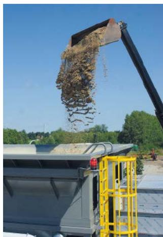
Abb. 2: Wenn das rote Signal leuchtet, verarbeitet der Wiegebunker noch Rohstoffe und der Kranführer muss warten. Dank der EVS-Funktion kann der Bediener das Signal sogar in der sehr hellen Umgebung Kenias eindeutig wahrnehmen.
