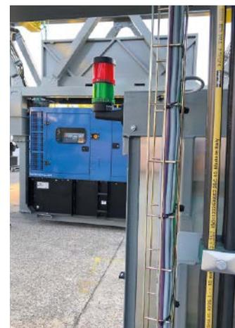
Abb. 3: An jedem Schaltschrank ist eine aufmerksamkeitsstarke Signalsäule KombiSIGN angebracht. Diese zeigt an, wann die Maschine fahrbereit ist. Die rote Lampe leuchtet, wenn ein Parameter nicht in Ordnung ist und Maßnahmen ergriffen werden müssen.
