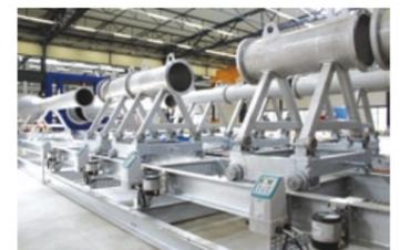
In Haguenau steht eine große Anzahl an Kalibrierungseinrichtungen mit unterschiedlichen Spezifikationen zur Verfügung. Dadurch lässt sich eine breite Palette an Produkten und Größen abdecken. Die Einrichtungen in Haguenau ermöglichen die Kalibrierung magnetisch-induktiver und Ultraschall-Durchflussmessgeräte in Größen von DN 2 bis zu DN 2000.
