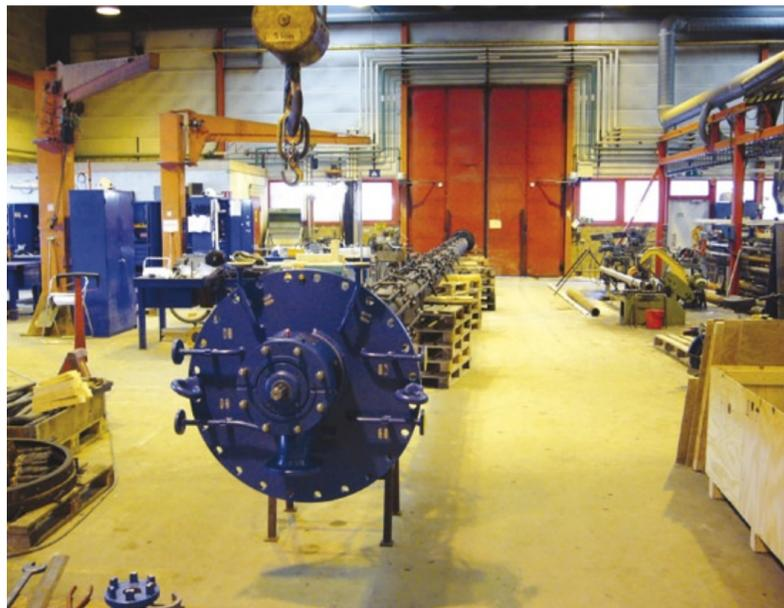
Abb. 1: Die 17 m lange Vertikalkreiselpumpe für einen Flüssigschwefeltank wurde in Einzelteilen an Kemira Kemi in Schweden geliefert und dort erneut zusammengesetzt.
