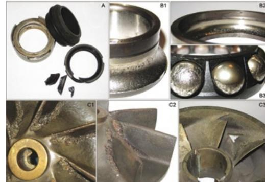
Abb. 2: Ausfallkritische Pumpenbauteile: Durch Trockenlauf zerstörte GLRD (A); Innenring (B1), Außenring (B2) und Käfig mit Wälzkörpern (B3) eines defekten Wälzlagers; durch Kavitationserosion zerstörte Laufräder einer Kreiselpumpe (C1–C3)
