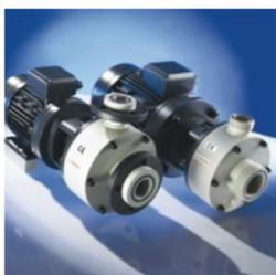
ASV Stübbe hat sein Pumpenprogramm um die leistungsstarke Kunststoff-Kreiselpumpe SHB mit Norm-Motor ergänzt. Sie ist speziell für die Anforderungen der Umwelttechnik und Oberflächentechnik konstruiert. Die Pumpe bewältigt Förderströme von bis zu 38 m<sup>3</sup>/h und Förderhöhen von bis zu 29 m. Mit der SHB schließt ASV die Lücke zwischen der kleinen KHB Baureihe (bis DN 25–125) und den großen Chemiepumpen der NMB-Klasse.
