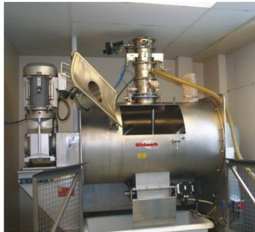
Der britische Vertragshersteller Surepharm Services installierte zum Transport von Pulverprodukten für die Tablettenherstellung drei Piab-Vakuum-Fördersysteme der C-Serie.
