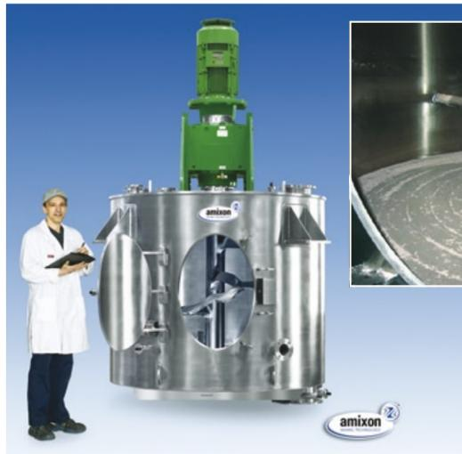
Abb. 1: Die Mischwerkende der neuen Generation von Amixon-Vertikalmischern ist geneigt und wahlweise wie eine Sinuswelle gestaltet. Dadurch wird die Mischeffizienz deutlich verbessert und der Entleergrad ganz wesentlich erhöht.
