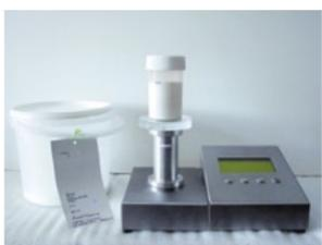
Mit Moist xLab, dem neuen Mikrowellen-Feuchtemess-System von Hf Sensor werden Trockenschrank und Feuchtwage für Labor-Feuchtebestimmungen ersetzt. Einzelstichprobenmessungen, die vielfach nicht repräsentativ sind, wurden bislang mittels aufwändiger Ofentrocknung oder Feuchtwagen durchgeführt. Moist xLab misst den Feuchtegehalt auf Knopfdruck in nur wenigen Sekunden. Das Laborgerät dient der
