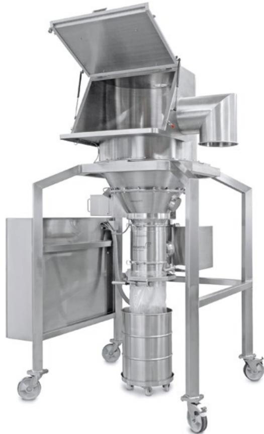
Abb. 1: In einem Schritt vom agglomerierten Schüttgut oder Pulver zum rieselfähigen, feinen Pulver. Auf der „DelumpWitt“ von Frewitt werden auch große Agglomerate wieder vollständig in die Primärpartikel übergeführt. Hier das Gerät als mobile Einheit.
