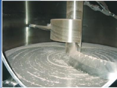
Abb. 2: In den neuen Amixon-Einwellenmischern für 2 m³ Mischgut bleiben nach der Austragung lediglich 240 g Feststoff übrig. Das ist ein Restentleergrad von 99,983 %.
