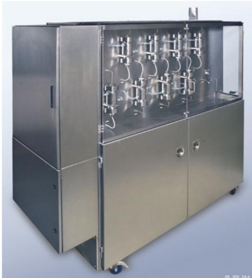
Abb. 3: BayCC50-Einheit, Vorderansicht mit Trennsäulen (links) und Rückseitenansicht mit Pumpen und Ventilen (rechts, ohne Abdeckplatte)
