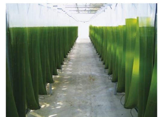
Abb. 2: Polyethylenschläuche mit Meeresalgen in der Algenproduktionsanlage unter hochtransparenter Glaseindeckung. Am unteren Ende der Schläuche wird die Biomasse entnommen.
