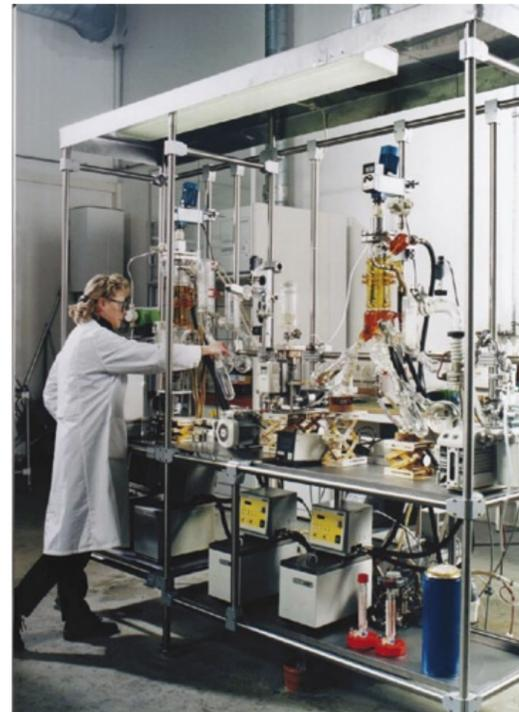
Durch Versuche im Labor- oder Technikaßstab werden bei VTA zuerst die richtigen Prozessparameter ermittelt, bevor große Chargen auf den Kurzweg- und Dünnschichtverdampfer-Anlagen im Lohn destilliert werden.
