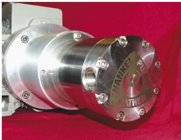
Abb. 1: Auf der Achema wird Gather Industrie dem Fachpublikum eine neuartige Wankelpumpe vorstellen. Die hermetisch dichte, pulsationsfreie und scherarme Multipurpose-Pumpe eignet sich besonders gut für Anwendungen in der Chemie, Verfahrenstechnik und der allgemeinen Anlagentechnik.
