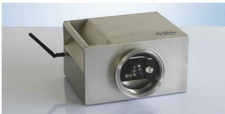
NIR-Spektrometer zur Überwachung von Mischprozessen direkt am Mischer
