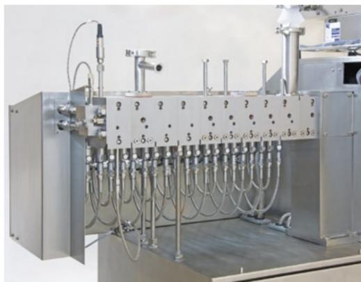
Abb. 1: ZSK 18 Megalab, mit einem Schneckendurchmesser von 18 mm die kleinste Ausführung der ZSK Megacomounder Plus-Baureihe, geeignet für Laboranwendungen als auch für den Produktionsbetrieb
