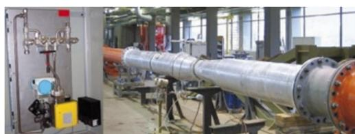
Die Dampfverrechnungsmessung mit Venturirohr nach ISO 5167 ist das derzeit verlässlichste Verfahren.
