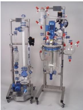
Die Systeme miniPilot 5 und miniPilot 10 von C3 Prozess- und Analysetechnik eignen sich besonders für gängige Anwendungen wie Destillation, Multikomponenten-Reaktionen, Extraktionen und Kristallisationen im Technikums- oder Pilot-Bereich.
