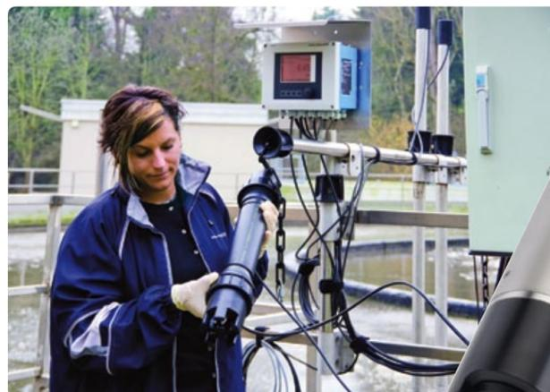
Abb. 2: Wartung eines ionenselektiven Sensors zur Ammonium- und Nitratmessung in der Kläranlage, der an einen Mehrkanal-Messumformer Liquiline angeschlossen ist.
