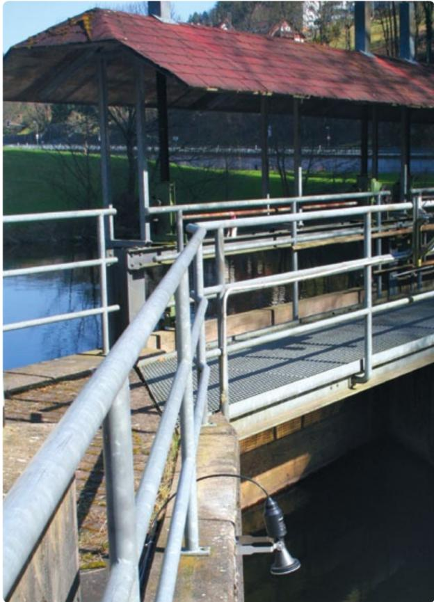
Abb. 1: Wo Romantik und HighTec aufeinander treffen: Einsatz der Vegapuls Radarfüllstandmesser im firmeneigenen Testgelände von Vega in Schiltach im Schwarzwald
