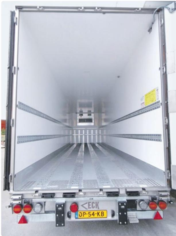
Schnelle und sichere Verladung: Platz für vier Main-Deck-Pallets, im Boden ist ein Heavy-Duty-Rollbahnsystem eingelassen, das die Luftfahrt-Norm der IATA erfüllt
