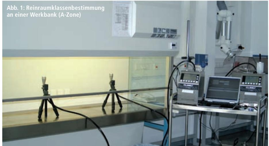
Abb. 1: Reinraumklassenbestimmung an einer Werkbank (A-Zone)
