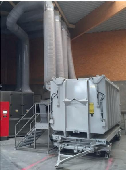
Abb. 2: Der Transportcontainer mit einem Nutzvolumen von 22 m<sup>3</sup> dient gleichzeitig zur Trocknung. Während der Trocknung ist er mit dem Entfeuchtungsmodul verbunden.
