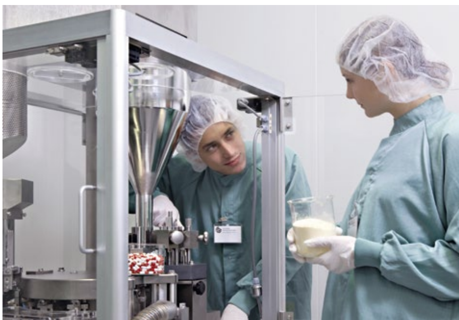
Abb. 3: Kapselherstellung im Reinraum
