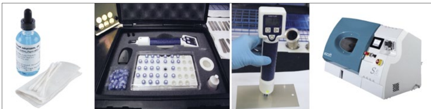
Abb. 1: Testsysteme zur Prüfung der Passivierung
