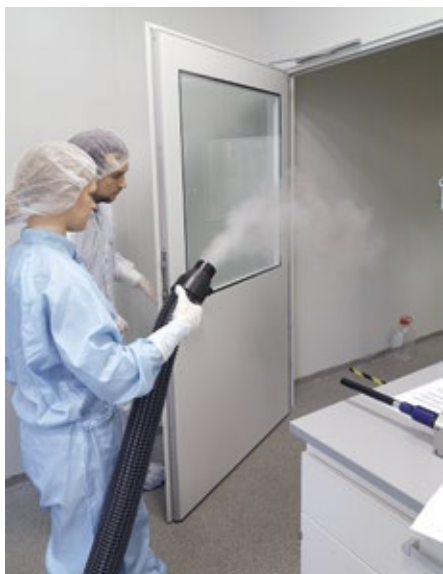
Abb. 6: Studierende führen eine Strömungsvisualisierung durch.
