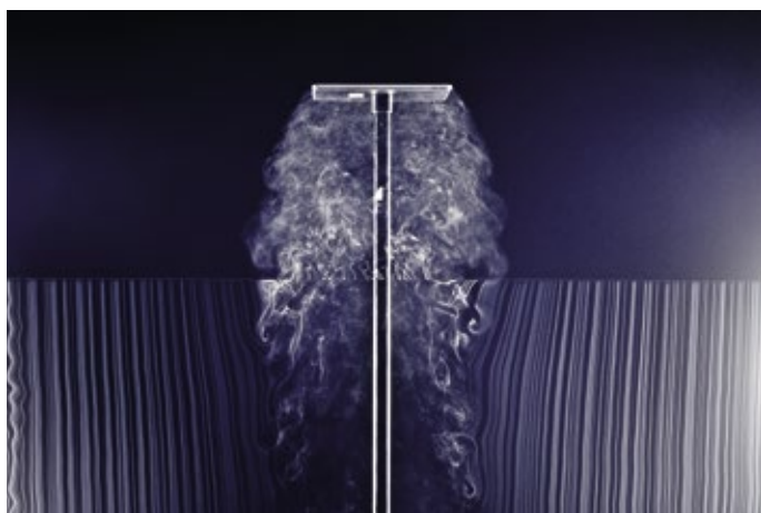
Abb. 4: Visualisierung des Rückströmgebiets unterhalb eines Hindernisses in einer turbulenzarmen Verdrängungsströmung
