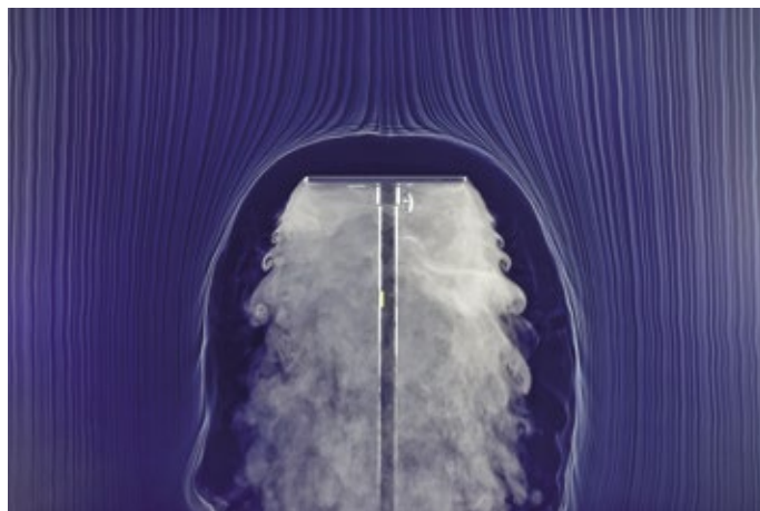
Abb. 3: Visualisierung der Umströmung eines Hindernisses in einer turbulenzarmen Verdrängungsströmung
