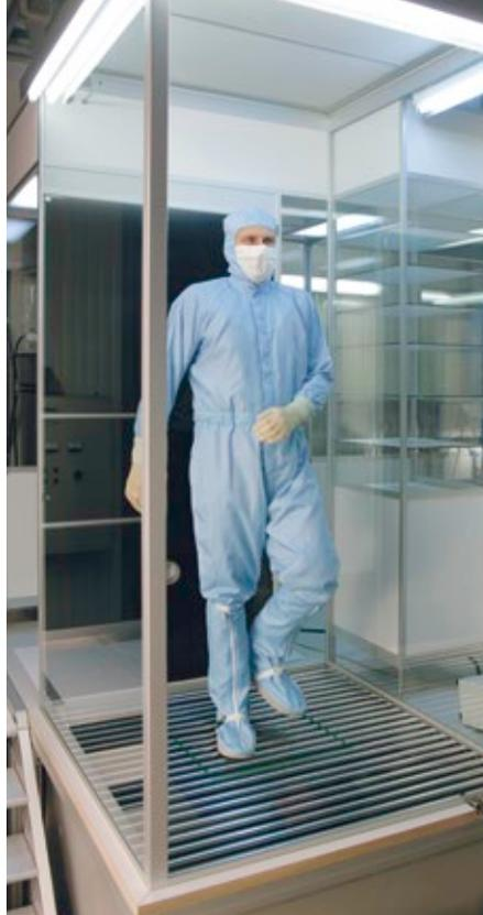
Abb. 3: Qualifizierung von Reinraumbekleidung mit Hilfe der Body-Box-Methode © dastex
