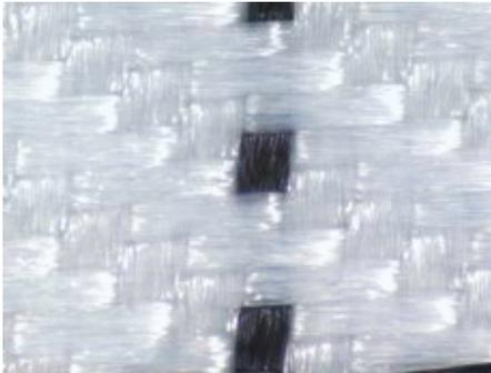
Abb. 2: Reinraumgewebe (3/2 Körperbindung) im Neuzustand. © dastex
