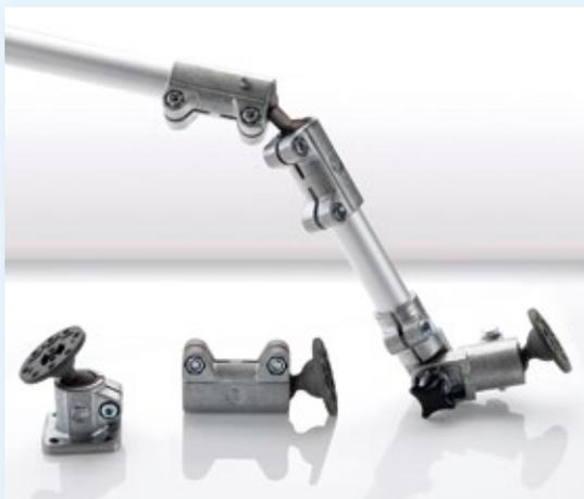
Gelenkklemmstücke integrierten Kugelgelenke sind für Belastungen bis 40 Nm (statisch) ausgelegt. Angeschlossene Anwendungen sind um 60° frei schwenkbar und um 360° frei drehbar. Damit bieten sie deutlich mehr konstruktive Freiheitsgrade als herkömmliche Gelenkverbinder. Eine spezielle Oberflächenbeschichtung des Kugelgelenks sorgt dabei für eine hochfeste Klemmung. Für die flexible Anbindung verfügen die Klemmstücke über eine Universalanschlussplatte.
