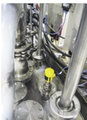
Das Radarfüllstandmessgerät Vegapuls 64 misst zuverlässig den Füllstand in den Produktionsanlagen von CHT in Dusslingen.
