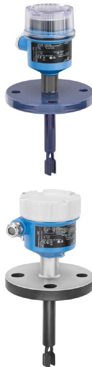
Abb. 4: Verschiedene Gabelbeschichtungen machen den Liquiphant unempfindlicher gegen extreme Prozessbedingungen (oben: Email; unten: PFA, leitfähig).
