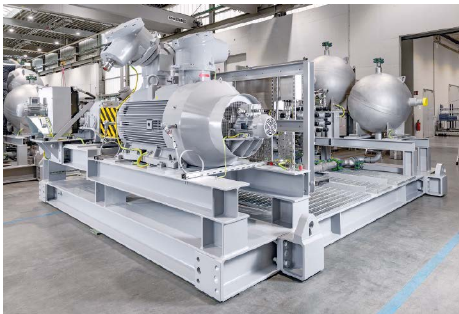
Abb. 2: Insgesamt sollen drei solcher Pumpen pro Förderzweig verbaut werden, wobei jeweils eine als Stand-by-Aggregat verfügbar gehalten wird.
