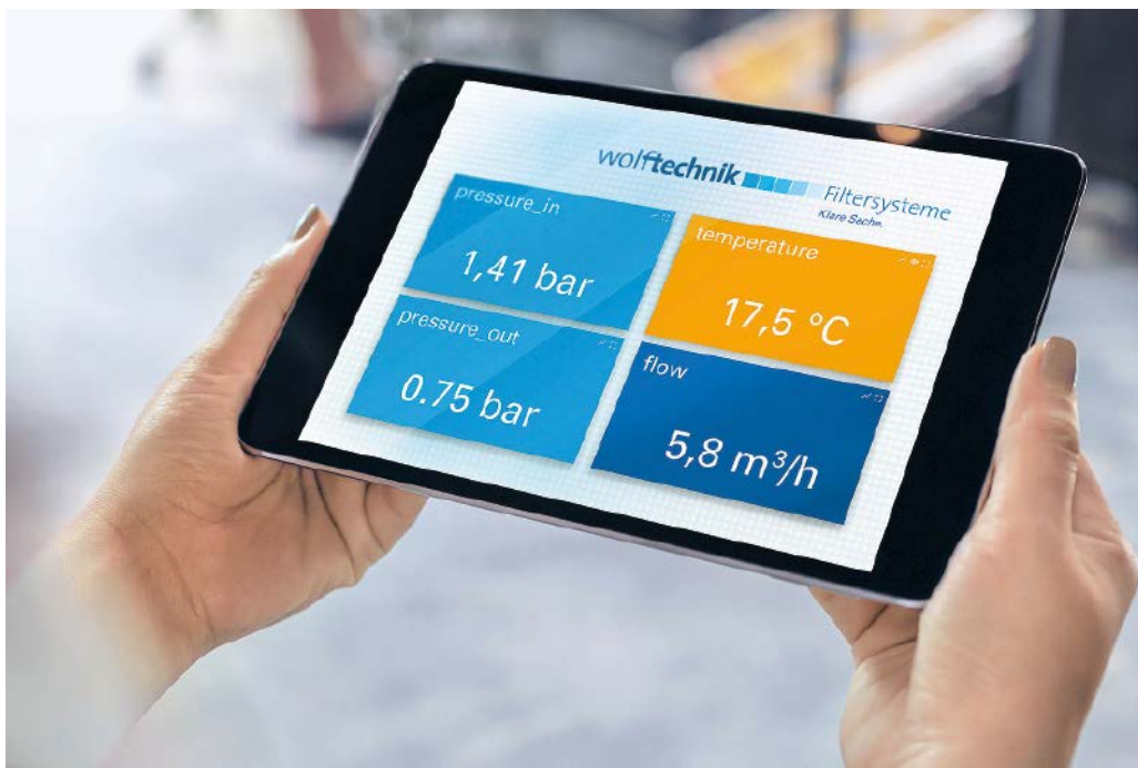
Abb. 3: Über ein Dashboard kann die smarte Filtration vollständig verwaltet werden. Hinweis: Dashboard zeigt eine mögliche Version
