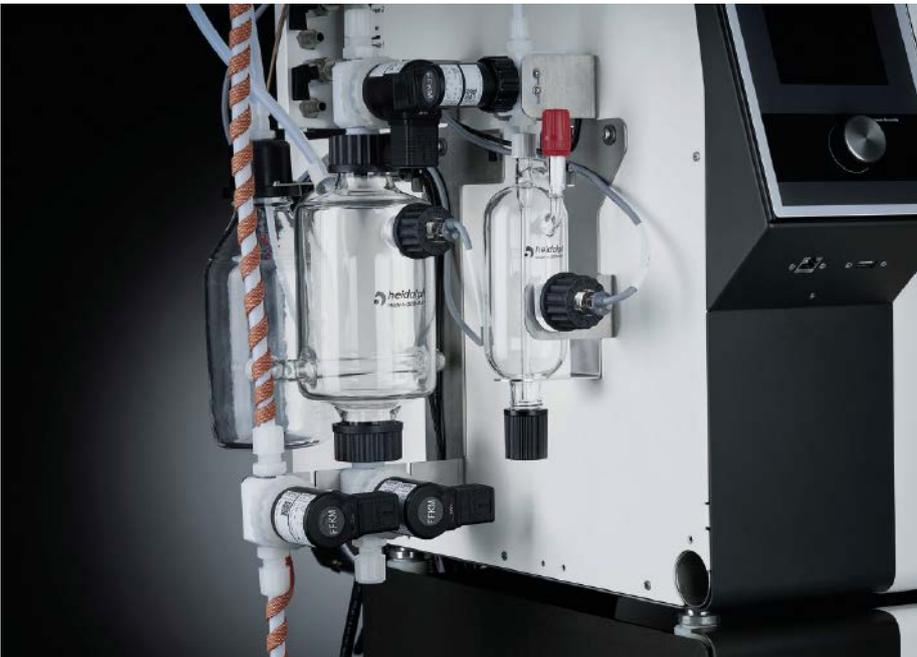
◀ Abb. 2: Um ein Überlaufen zu verhindern und den optimalen Zyklus aus Verdampfen, Abführen und Nachfüllen zu gewährleisten, stellen verschiedene kalibrierfreie Sensoren den Betrieb sämtlicher Modulkomponenten sicher.
