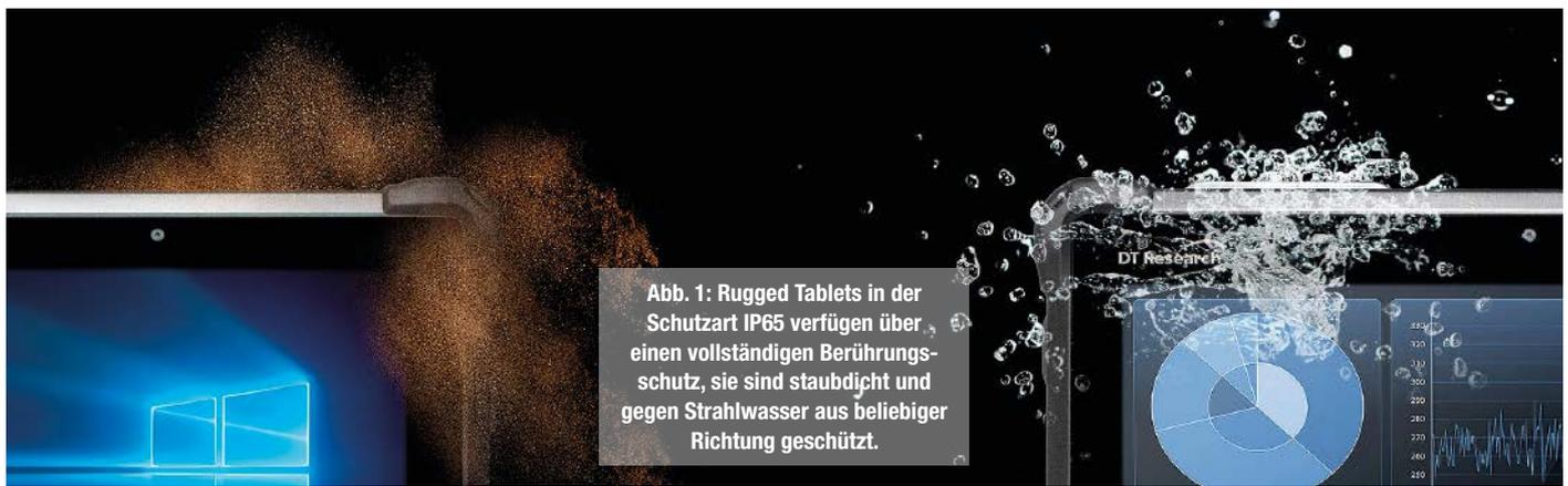
Abb. 1: Rugged Tablets in der Schutzart IP65 verfügen über einen vollständigen Berührungsschutz, sie sind staubdicht und gegen Strahlwasser aus beliebiger Richtung geschützt.
