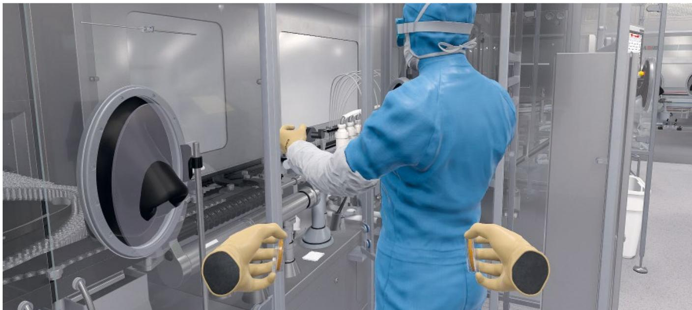
▲ Abb. 1: Operator bei Intervention vor Sterilabfülllinie
