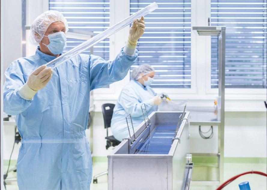
Bearbeitete Teile gelangen durch eine Reinigungsschleuse (rechts) in den Reinraum, wo sie montiert und verpackt werden. Große Teile wie die hier gezeigte Komponente für einen Bioreaktor werden in einem Ultraschallbecken mit hochreinem Osmose-Wasser gereinigt. © Ensinger
