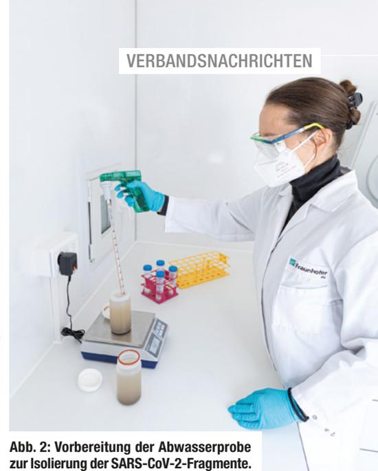
Abb. 2: Vorbereitung der Abwasserprobe zur Isolierung der SARS-CoV-2-Fragmente.
