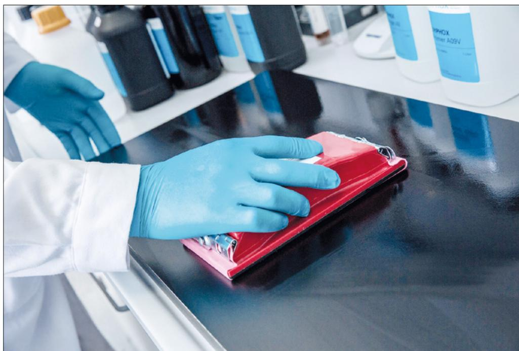
**Abb. 2: Applikation der antimikrobiellen Beschichtung Dyphox auf einem schwarzen Untergrund im Labor**
