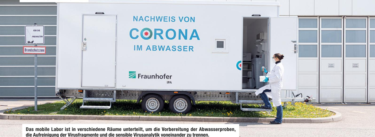
Das mobile Labor ist in verschiedene Räume unterteilt, um die Vorbereitung der Abwasserproben, die Aufreinigung der Virusfragmente und die sensible Virusanalytik voneinander zu trennen.
