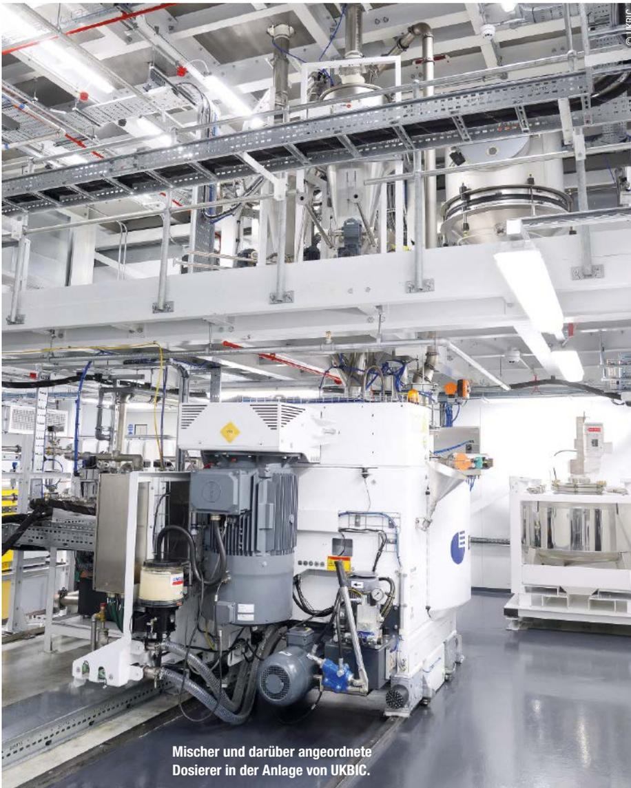
Mischer und darüber angeordnete Dosierer in der Anlage von UKBIC.
