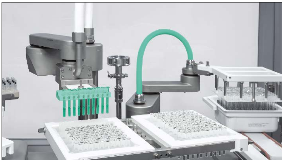
▲ Abb. 1: Die modulare und innovative Plattform für RTU- und Bulk-Behältnisse umfasst vorentwickelte und vortestete Module, die eine Ausbringung von bis zu 3.600 Behältnissen pro Stunde ermöglichen. Zudem bietet Versynta FFP eine 100%-ige In-Prozess-Kontrolle.
