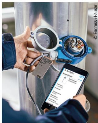
die Basis für vorausschauende Wartung. Über die Bluetooth-Schnittstelle lassen sich die Messgeräte einfach mit der SmartBlue-App konfigurieren und verifizieren. Selbst mit extremen Anwendungsbedingungen kommen sie gut zurecht. Intelligente Funkti-
