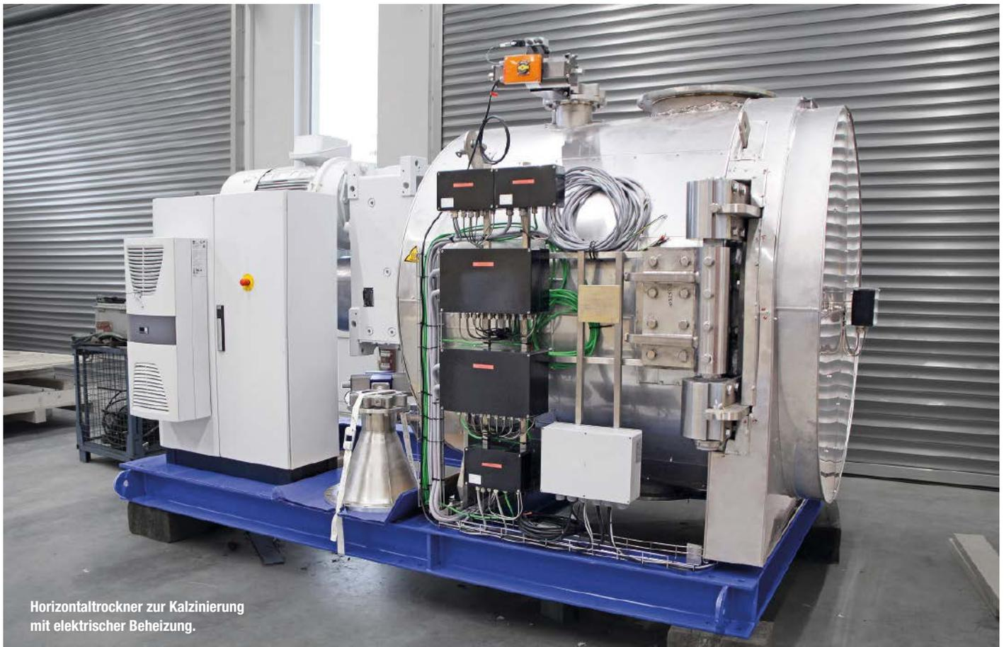
Horizontaltrockner zur Kalzinierung mit elektrischer Beheizung.
