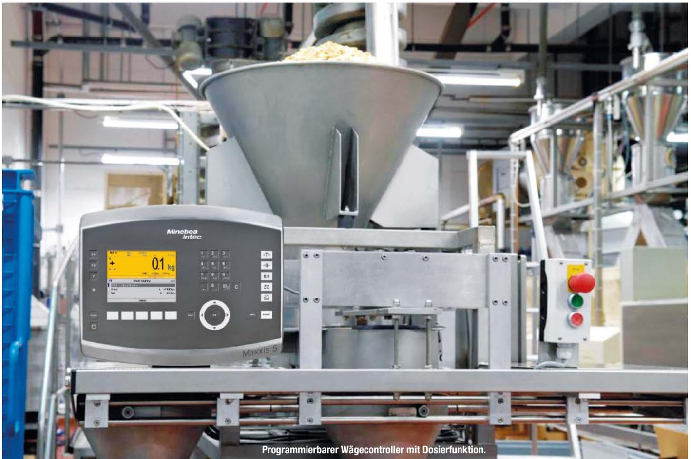
Programmierbarer Wägecontroller mit Dosierfunktion.
