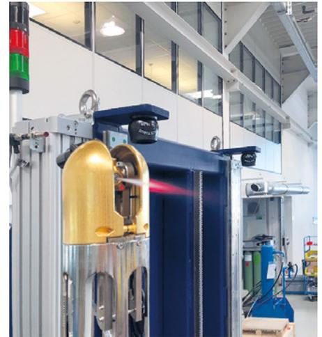
▲ Durch die beiden in den Düsenkopf integrierten Laserpointer lässt sich der Abstand zu den zu reinigenden Innenflächen optimal festlegen. © OHB System
