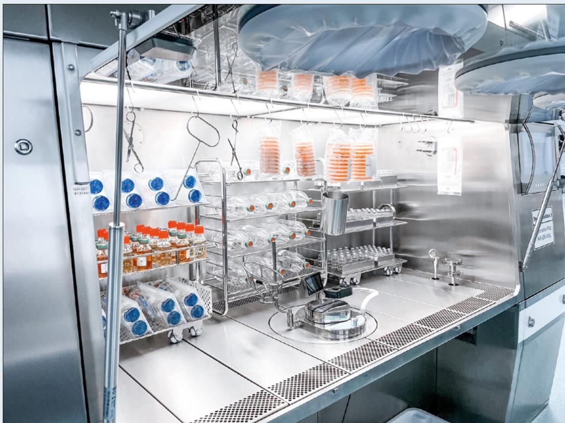
Abb. 3: Beladener STISO: Die Dekontamination der innenliegenden Oberflächen beginnt in Kürze, um anschließend die Sterilität der Arzneimittel in den Behältern prüfen zu können.
