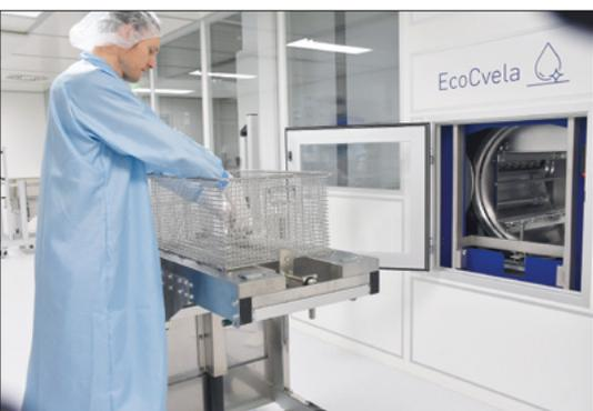
**Im Endreinigungsbereich, der sich in einem validierten Reinraum der Klasse ISO 7 mit Zonen ISO 6 befindet, können Reinigungsversuche mit höchsten Sauberkeitsanforderungen, bspw. Grade 2 und 1, durchgeführt werden.**
