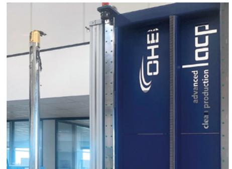
▲ Der schwenkbare Düsenkopf ist auf einer Lanze montiert, durch deren Öffnungen die entfernten Verunreinigungen abgesaugt werden. Der Sauberkeitsnachweis erfolgt durch einen in den Abluftstrom integrierten Partikelzähler. © acp systems
