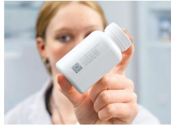
Der Domino U510 UV-Beschriftungslaser ist dank einer photochemischen Reaktion nicht auf laseraktive Pigmente/Additive oder speziell präparierte Codierfelder angewiesen. © Domino
