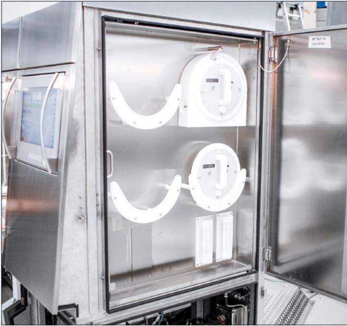
**Abb. 4: Die korrekte Funktion der Handschuhprüfplatten lässt sich unmittelbar am STISO überprüfen.**
