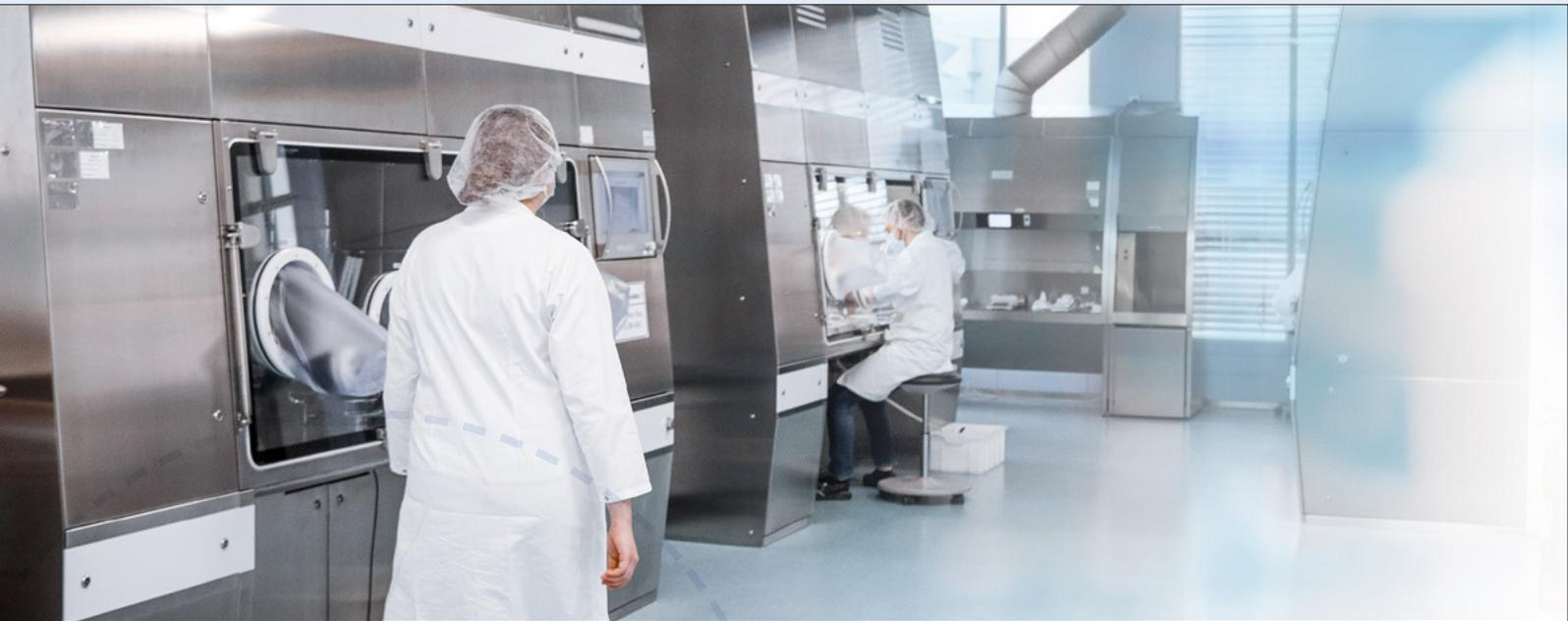
Die ursprünglich fünf geplanten Sterilitätstestisolatoren deckt das pharmazeutische Unternehmen heute mit nur drei STISOs ab. Zwei STISO Sterilitätstestisolatoren (links im Bild) stehen raummittig, ein dritter ist rechts wand- und deckenbündig installiert.
