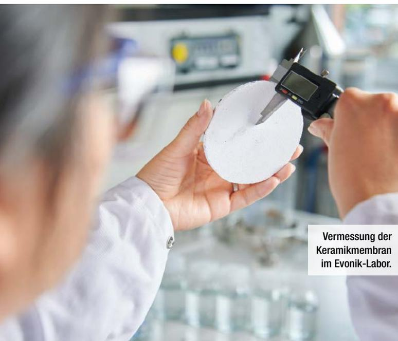
Vermessung der Keramikmembran im Evonik-Labor.
