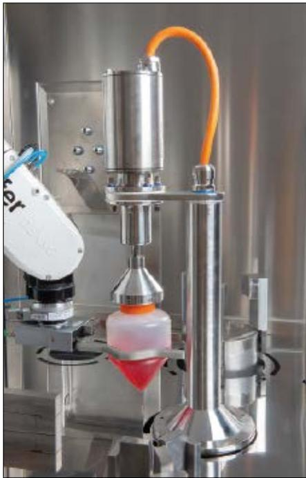
gezeichnete Dekontamination und Sterilisation ermöglicht. Der spezielle Hygienemotor sowie die übrigen außenliegenden Komponenten bieten durch den Einsatz von Edelstahloberflächen sowie Hygienedichtungen höchste chemische Beständigkeit und somit Resistenz gegen Wasserstoffperoxid und alle gängigen Reinigungsmittel.
