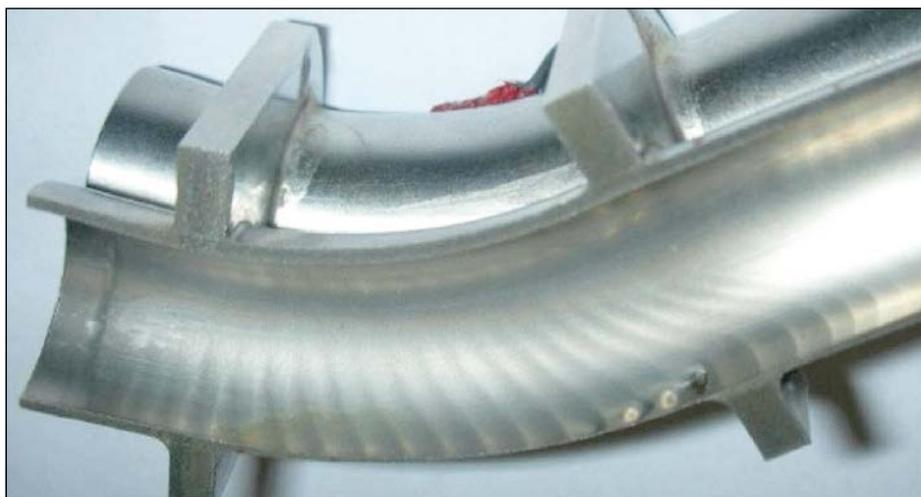
Abb. 1: Sichtbare Abnutzung im Coriolis-Messrohr durch Abrasion.
